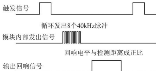
图 2 HC-SR04 超声波时序图
